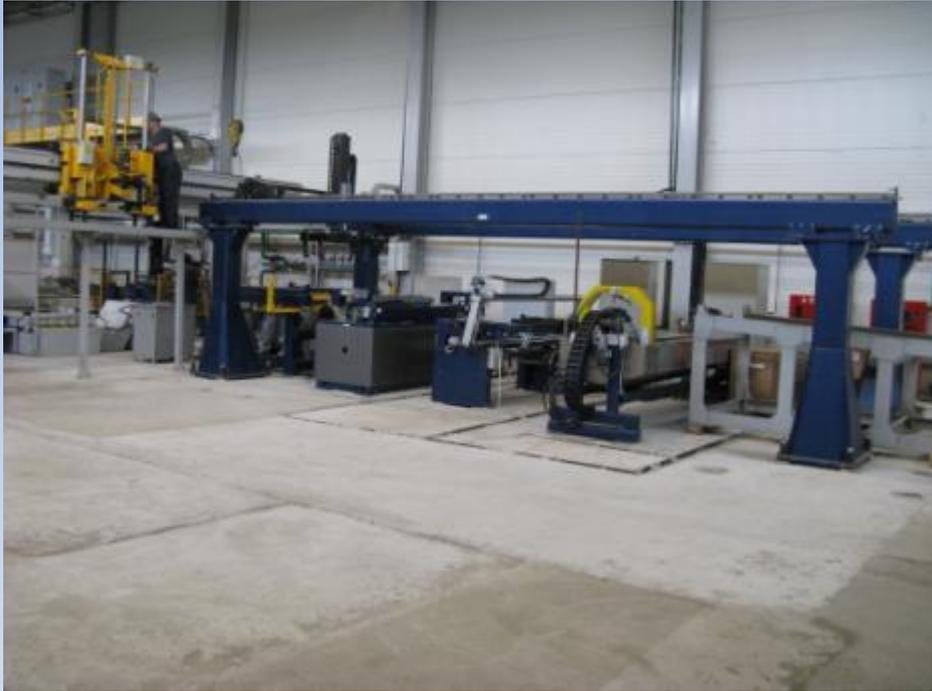
10. Выходной размерный геометрический ультразвуковой и магнитопорошковый контроль
