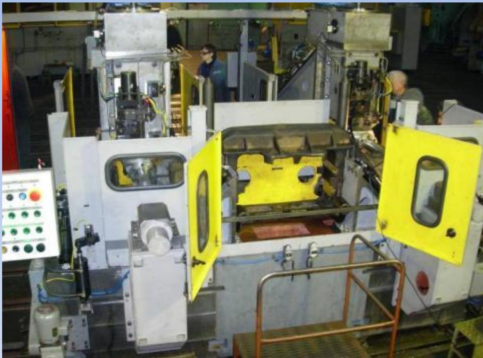
Фрезеровка одновременно опорных
