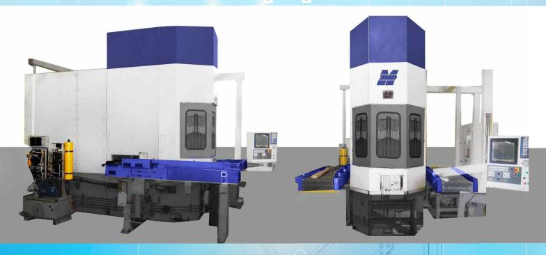
Станок – инвертор предназначен для наружной и внутренней токарной обработки деталей типа тел вращения. На станке возможна обработка вращающимся инструментом (сверла, метчики, фрезы).
