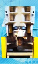
Шпиндель с закрепленной в патроне деталью расположен вертикально над неподвижно установленном внизу инструментом и деремещается по осям X и Z.
