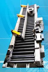
Обработка деталей на станке полностью автоматизирована: передача заготовки из предстаночного магазина на загрузочную позицию шпинделя и передача обработанной детали на отводящий рольганг осуществляется внутристаночным шаговым транспортером.
