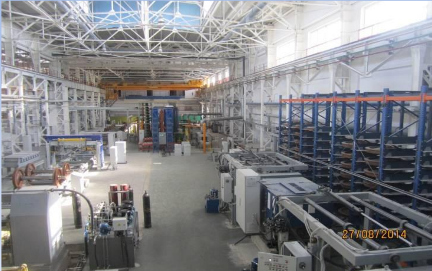
Цех по сборке колесной пары нового формирования с буксовыми узлами
