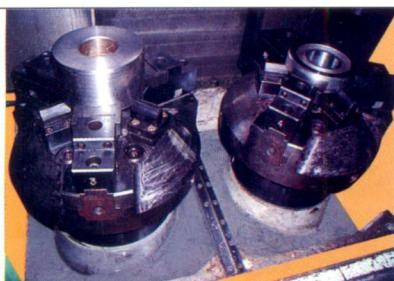
Два патрона двухшпиндельного станка позволяют обработать деталь с двух сторон без промежуточного складирования.
