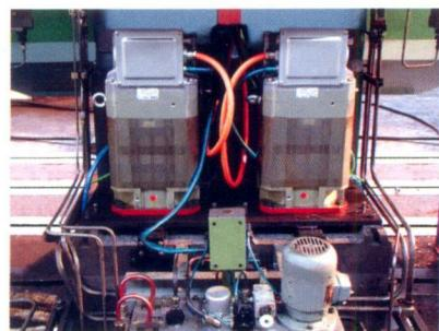
В задней части литого основания станка установлены 2 привода главного движения, укомплектованные асинхронными электродвигателями SIEMENS с частотным регулированием, которые через поликлиновые ремни передают вращение на шпинделем левой и правой шпиндельных бабок, установленных на переднюю стенку основания.
